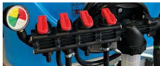
Mandos, distribuidor y manómetro
