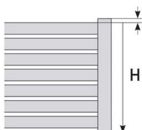
Le dépassement du poteau (capot inclus), pour tous les remplissages, est de : 31 mm en pose sur platine
