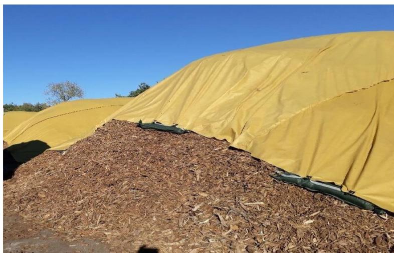
SUBTEX® 200 est une toile de protection en polypropylène non tissée de 200gr/m. C'est la solution pour protéger vos composts, fumiers, plaquettes de bois et fientes de la lixiviation des nutriments. La bâche est très souple, il faut donc la tendre le plus possible afin que l'eau ruisselle dessus.
