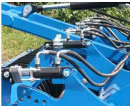
Contrôle de profondeur hydraulique du rouleau optionnel
