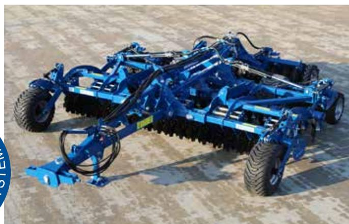
H SP - Machines à pliage hydraulique en version semi-portée, la largeur de transport ne dépasse pas 3 m.
