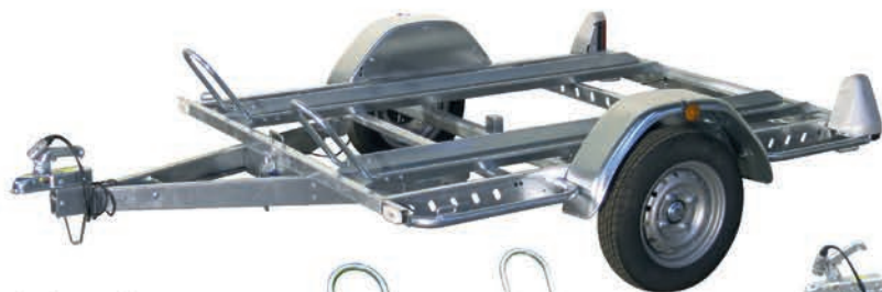
Option rails porte-motos + rampe de montée
